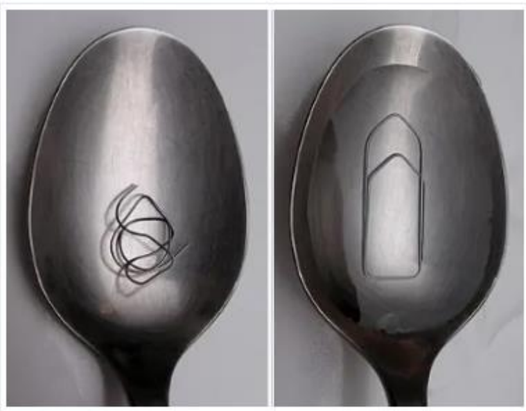
قرار دادن گیره کاغذ از جنس نیتینول در آب داغ و بازگشت آن به شکل اولیه
